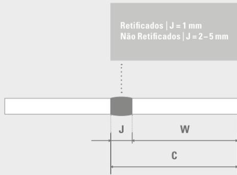
**Dimension de Fabrication (W) = Dimension de la face visible (a e b) et épaisseur (d)**
