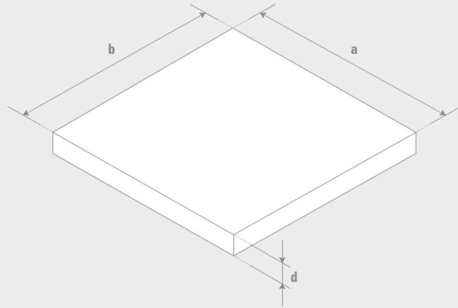
**Dimensão de Fabrico (W) = Dimensão da face visível (a e b) e espessura (d)**
