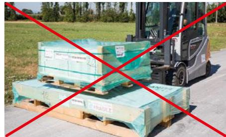
IT Per movimentare correttamente il pallet sul lato lungo si raccomanda di allargare al massimo le forche e di posizionarle al centro del pallet, far presa su tutta la profondità prima di sollevare.
